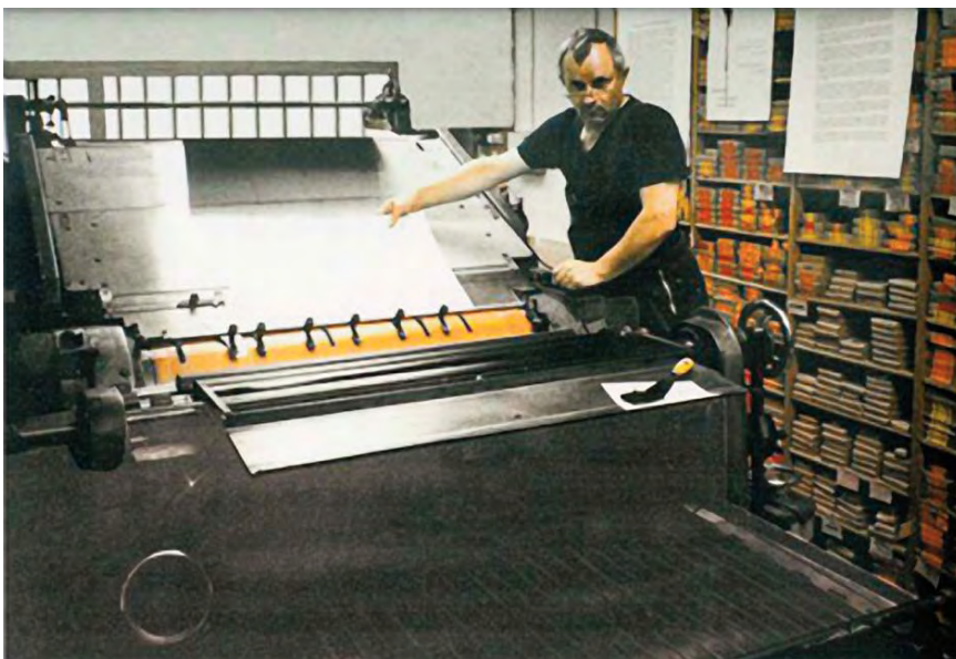
machine typographique Albert Frankenthal (70x102), transformée en marge manuelle (réversible) par François DA ROS, pouvant imprimer sans gâche tous les papiers, du plus léger au plus lourd.
