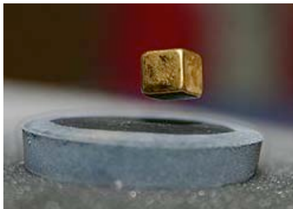
Lévitation d'un aimant au-dessus d'un matériau supraconducteur refroidi à l'azote liquide
